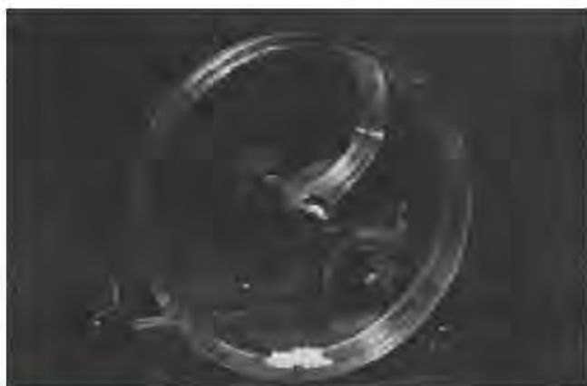
Figure 45-37. The Roche friabilator (courtesy, Hoffmann-LaRoche).
