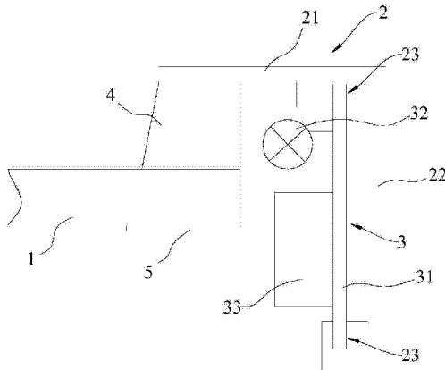
1. 一种新型红外触摸屏,其特征在于:包括屏体、装嵌屏体的矩形边框以及位于所述矩形边框内且围绕屏体设置的红外触控组件,所述矩形边框包括平行于屏体的前壁和垂直于屏体的侧壁,所述前壁探至屏体边沿的前方并通过滤光条与屏体连接,所述红外触控组件包括平行于侧壁设在矩形边框内的PCB板以及若干设在所述PCB板上、位于滤光条外侧且紧贴屏体前表面所在平面的红外管,所述红外管包括分别位于矩形边框的左边框和下边框的红外发射管,以及分别位于右边框和上边框的红外接收管。
