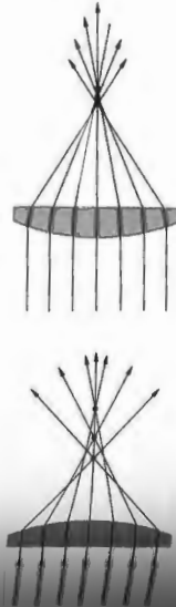
Figure 6.16 SA for a planar-convex lens.
