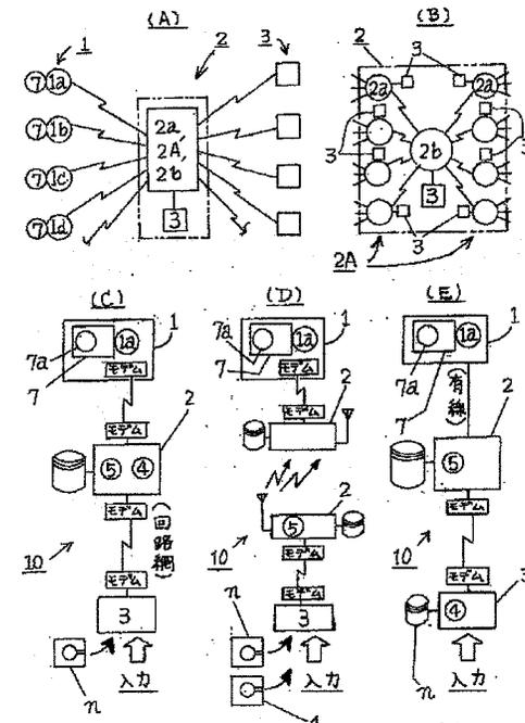
置3から、作成した表示予約情報mを入力して、子局1に広告または報知の表示をするようにした広告等施設の広告等表示制御システム10であって、音声または文字、映像を含む表示予約情報mの表示データ作成を補助する表示内容作成支援ソフト4と、一定基準に従い特定する単数または複数の表示予約すべき子局1の選択、表示継続時間tと掲示予約時間帯Tとの設定、複数表示予約の編集および料金またはコストcの算定と徴収を含む表示業務関連手続き処理Pをそれぞれ補助する表示内容掲示支援ソフト5とを用いて、子局1向けの表示予約可能な表示予約情報mを作成して、表示予約情報mを直接あるいは所定記録媒体nに記憶保持した上、記録媒体nを介して任意の特定端末装置3に入力することによって特定子局1に対する表示予約を完了し、特定端末装置3から親局2を介して、予約した設定条件の下で表示予約情報mの表示を特定子局1に実行させることを特徴とする広告等表示制御システム。
