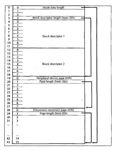
Figure 12.4 Example of a mode parameter page.
