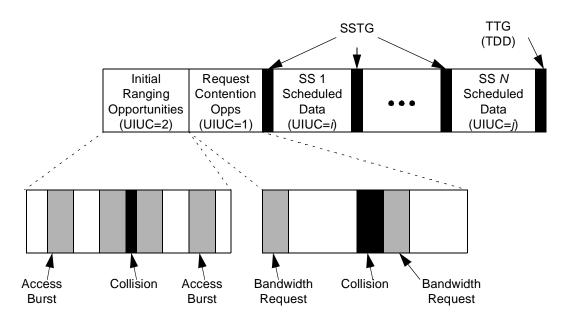
Figure 154—Uplink subframe structure
