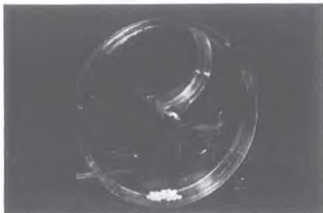
Fig 90-4. The Roche friabilator (courtesy, Hoffmann-LaRoche).
