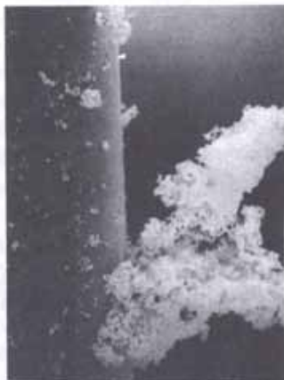
BILD 5 RUßPARTIKEL UND AGGLOMERATE AUF EINER RUßFILTERFASER
